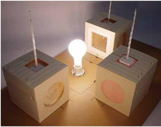
箱模型実験は、建物に見立てた箱に、断熱材や蓄熱材、遮蔽材、窓材などをいろいろな組合せで取り付け、それを太陽に見立てた電球で照らしたり消したりして、箱内部の温度変化のちがいをみる実験です。
