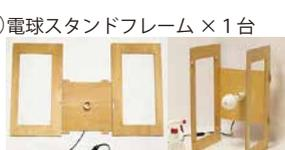
広げて「箱模型実験」に、立てて「すだれと霧吹きの実験」に使います。
